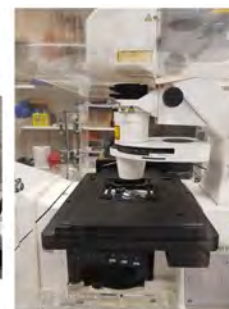
Platine motorisée dans une enceinte thermostatée et contrôlée en CO 2
