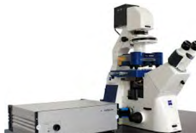
Module CellHesion avec AFM NanoWizard III
